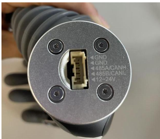
图 5 Revo 2基础版 通讯接口外观示意图
