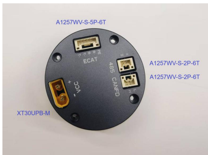
图 6 Revo 2进阶版/触觉版 通讯接口外观示意图
